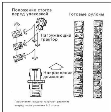
Стога привезти на место упаковки и расположить так, чтобы они были легко доступны для трактора, нагружающего упаковочную машину. Стога разместить параллельно на достаточном расстоянии друг от друга.
