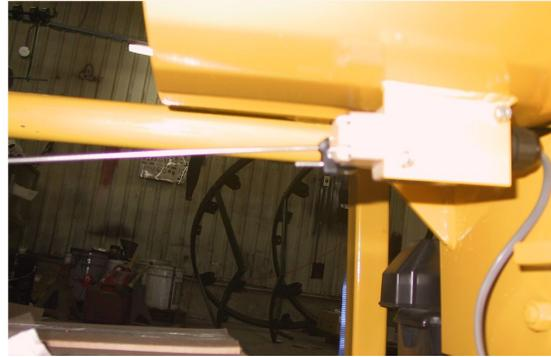
фото #3 предохранительный выключатель фото #4 концевого выключатель для пластика
